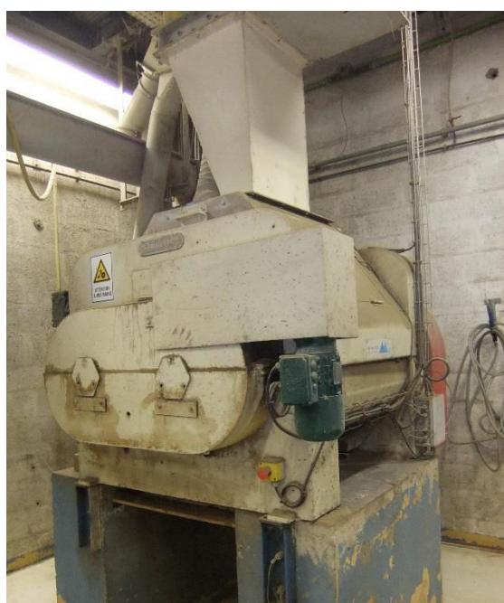
Figure II-2 : Aplatisseur à rouleaux (OLEAD, Pessac)
