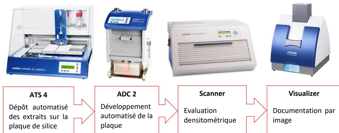
Figure II-12 : Les différents modules de l'HP-TLC
