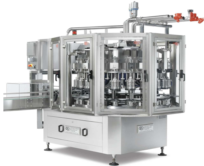
Figure 4 : Exemple d'une juteuse rotative sous vide (www.stvmachinery.it)
