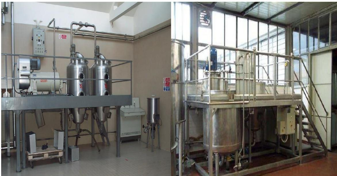
**Figure I.8 :** Dispositifs d'extraction par ultrasons (2 X 500 L), l'échelle industrielle pour produits liquides et solides permettant l'extraction semi continue (Reus-[www.etsreus.com](http://www.etsreus.com))
