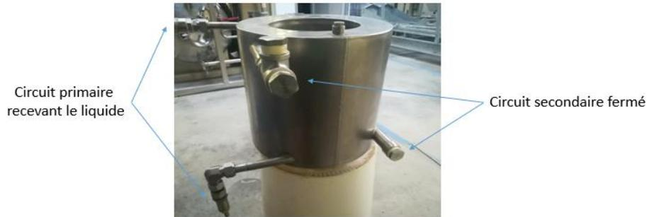
Figure IV.14 : Condenseur utilisé pendant les extractions MO/C des écorces d'oranges.
