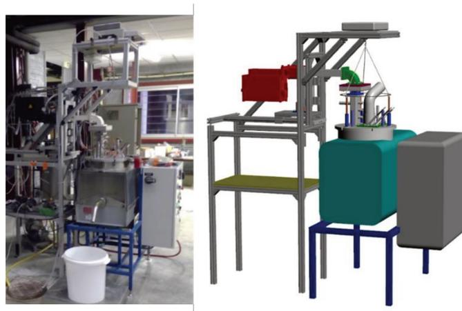
Figure II.1 : Dispositif expérimental en version déshydratation par essorage/micro-ondes : vue d'ensemble et représentation schématique (Apaolaza, 2014).
