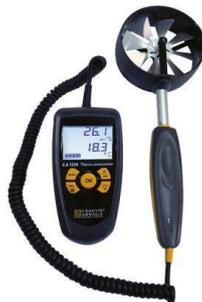
Figure IV.15 : Anémomètre à hélices Chauvin Arnoux 1052.
