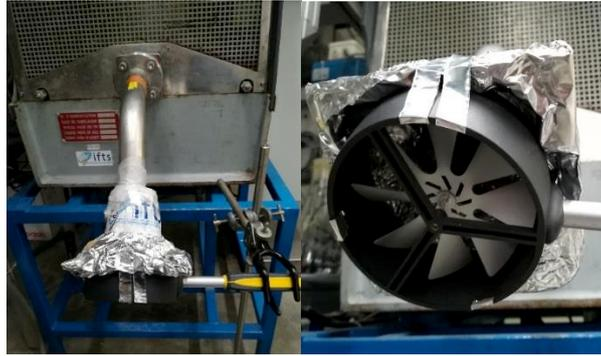
Figure IV.16 : Installations nécessaires pour réaliser les mesures de vitesses d'air avec l'anémomètre à hélices.
