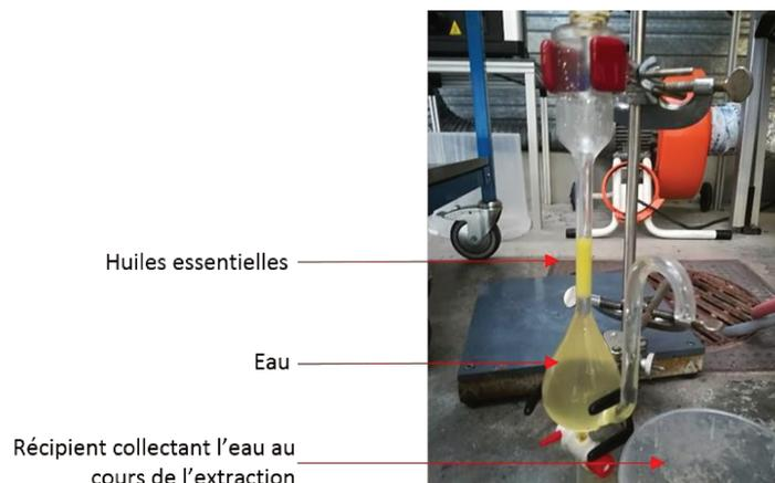
*Figure II.13 : Photographie du vase florentin en sortie du pilote pour collecter les huiles essentielles après passage dans un réfrigérant.*
