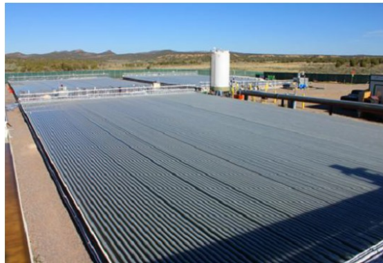
Figure I-12 : Photographies de différentes installations de PBR tubulaires. A gauche : PBR hélicoïdal, vertical Murdoch University, Australie (Chisti, 2007). A droite : PBR tubulaire horizontal immergé dans l'eau, Solix's Lumian™ Algae Growth System
