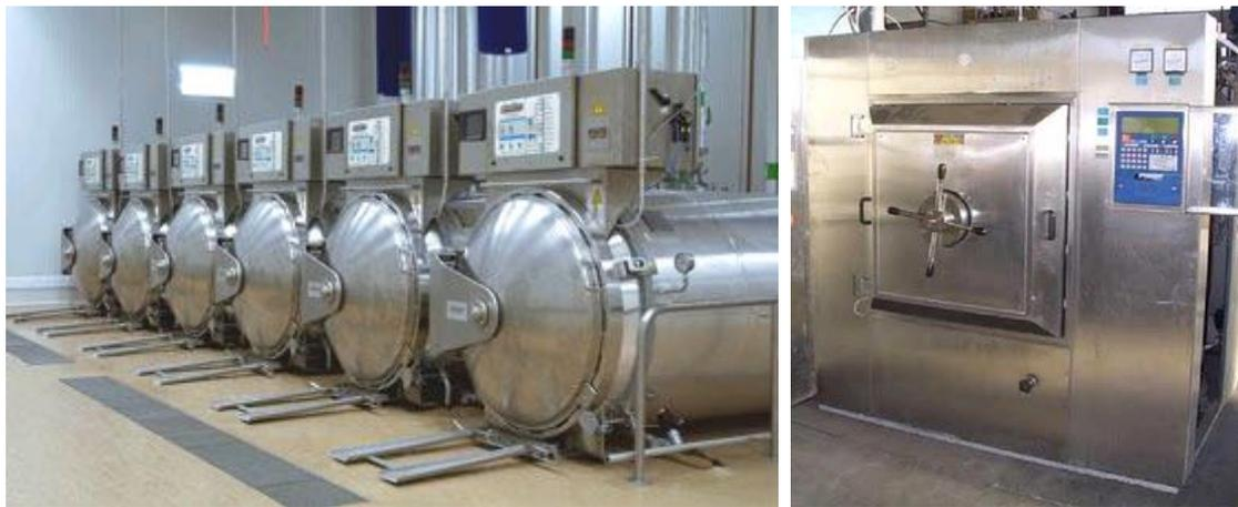
**Figure 2:** Deux exemples de stérilisateur statiques (Exapro, 2010; Steriflow thermal processing, 2010).
