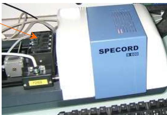
**Figure 34** : Spectrophotomètre utilisé pour le suivi de la dégradation des caroténoïdes en système micellaire aqueux, directement en macrocuves ; et pour les dosages après prélèvements dans le milieu réactionnel.
