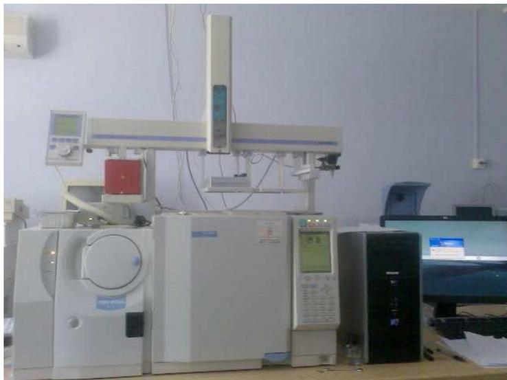
**Figure 44** : Equipement GC-MS pour l'identification des produits secondaires de la peroxydation lipidique.
