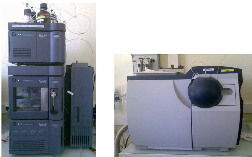
**Figure 45** : Equipement UPLC-MS utilisé pour l'analyse des caroténoïdes et l'identification de leurs produits de dégradation.
